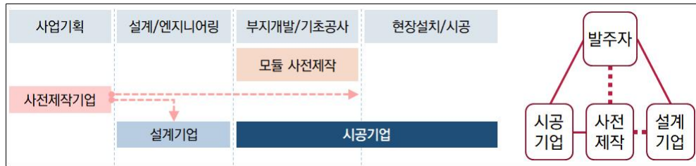
〈그림 5〉 제작-설계-시공 선정 사업의 추진절차 및 참여 주체 간 협력 관계
