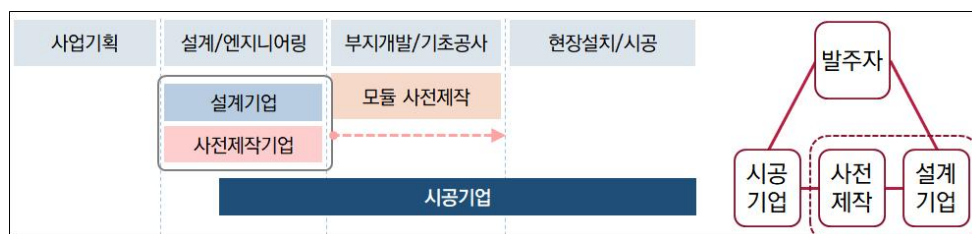
〈그림 6〉 설계+제작 결정 후 시공 선정 사업의 추진절차 및 참여 주체 간 협력 관계
