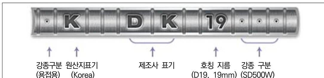
〈사진 1〉 철근의 원산지 표기 예(SD500W D19 철근의 경우)
