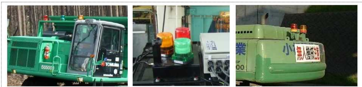
<그림 3> 자동 건설 기계의 안전 확보를 위한 표시등 사례
