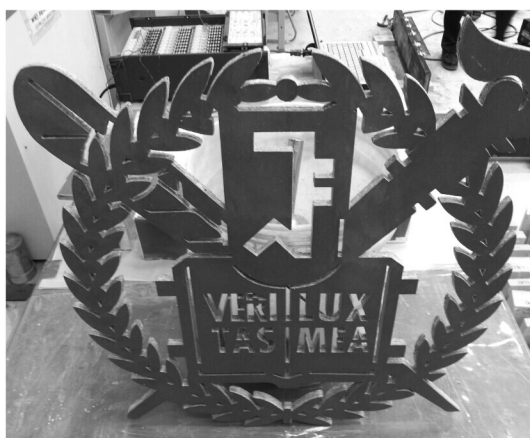
〈그림 4〉 UHPC를 활용한 로고 패널 제작
