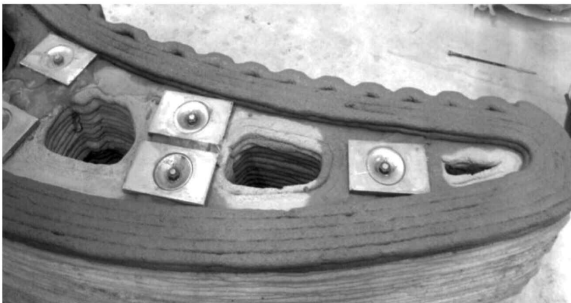
포스트텐션이 가능한 3차원 콘크리트 프린팅 구조물 사례(영국 Loughborough University).
