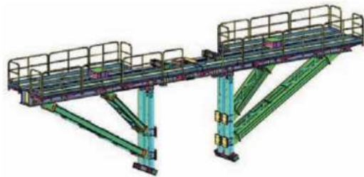
(c) 인양을 위해 주탑 가로보에 설치되는 Heavy Lifting용 Frame
